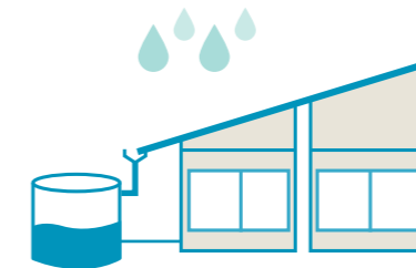
Fig. 5: Captación de agua de lluvia
